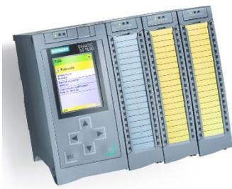
Essais de communication par OPC-UA entre Orchestra (logiciel de supervision) et une configuration matérielle physique. L'automate est un modèle de la gamme S7-1500F, équipé de cartes d'entrées sécuritaires.
